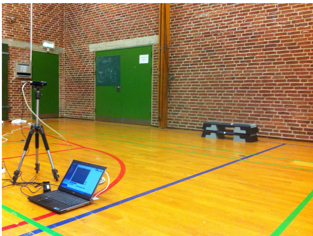
Billede 5 – Forsøgsopstillingen. Tapemarkeringen på den nederste stepbænk angav midten, hvorudfra highspeedkameraet blev placeret.
