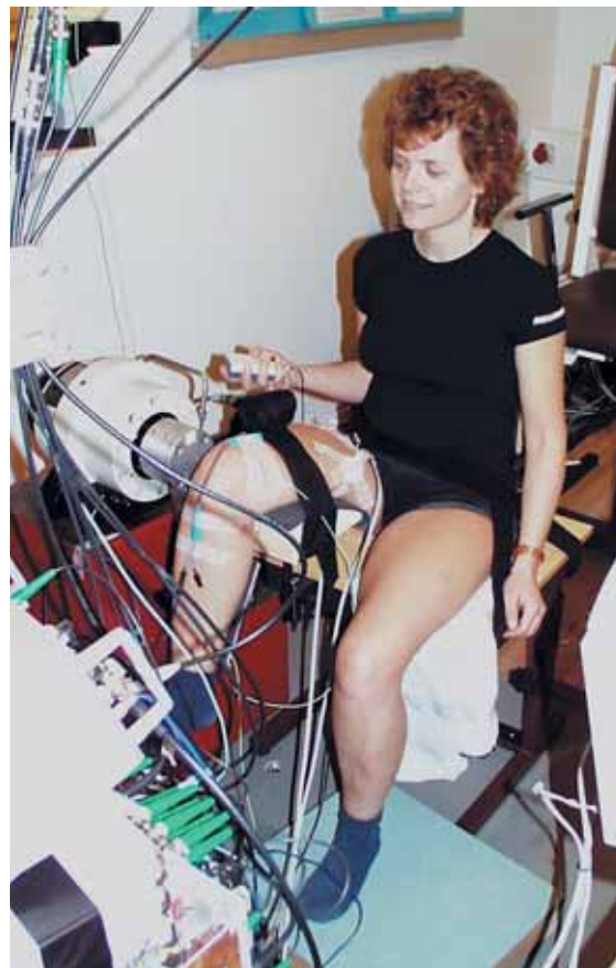
Forsøgsopstilling. Forsøgspersonen trykker på stopknappen, når hun kan mærke en begyndende smerte bag på benet eller i ryggen.
