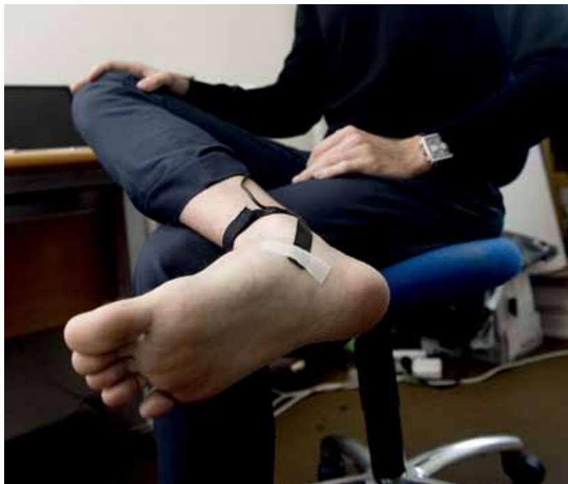
Fodsensoren er den sorte strimmel, som er fæstnet med et stykke tape. Strimlen er elastisk og registrerer alle bevægelser ned til 0,1 mm.
